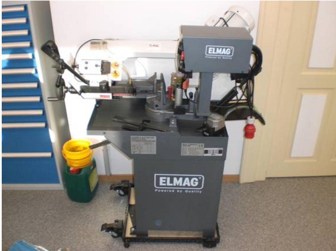
Für den Zuschnitt von Stangenmaterial bestens geeignet: Biegelbandsäge
