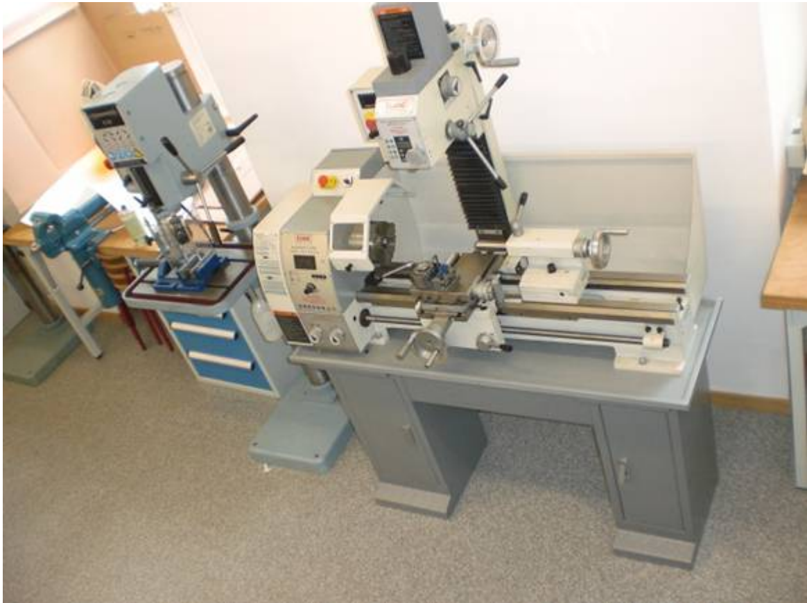
Hier die Drehbank mit dem Bohr-Fräskopf. Diese Maschine erlaubt es uns den SchülerInnen einen Einblick in die Zerspantechnik zu geben.
